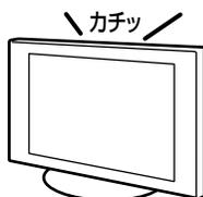
電源を入れたときは、内部の回路が動くため音がします。また電源スタンバイ時は、データ受信やソフトウェアの書き換えのために本機の電源が自動的に入り、音がすることがあります。本機前面の☒☑ランプがオレンジ色に点滅しますが、故障ではありません。
