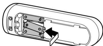
本機にACアダプターを接続すると、乾電池が入っていても自動的にコンセントからの電源に切り換わります。
