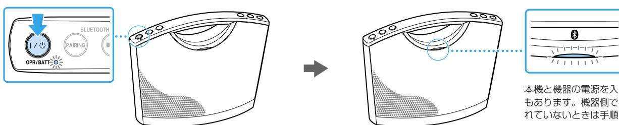
本機と機器の電源を入れただけで接続される場合もあります。機器側で接続状態を確認し、接続されていないときは手順2に進んでください。
