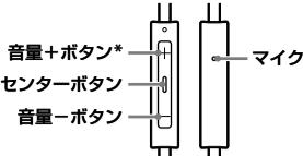
\* 音量+ボタン近くに凸点が付いています。操作の目印としてお使いください。
