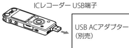
USB ACアダプター(別売)を使って、ICレコーダーと家庭用電源(コンセント)をつないで内蔵充電式電池を充電したり、ICレコーダーを使用することができます。充電をしながらICレコーダーを使用することができるため、長時間録音をする場合などに便利です。
