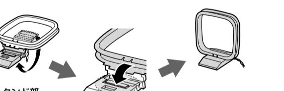
2 本機背面のAMアンテナ端子に、アンテナコードのAMアンテナ端子を差し込む。
