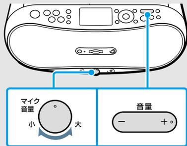
音量ボタンとマイク音量つまみで音量を調節する
