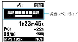
上段に録音中の入力レベルが表示されます。下段の白いバーは、入力レベルの適正範囲を表示します。
