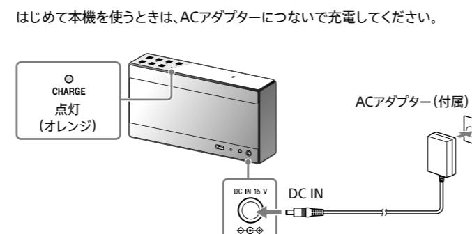
本機をACアダプターでコンセントにつなぐと、充電が始まり、CHARGE(充電)ランプがオレンジ色に点灯します。約4時間で充電が完了し、ランプが消灯します。
