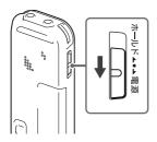
画面が表示されるまで、ホールド・電源スイッチを「電源」の方向へスライドさせると、「アクセス中…」のアニメーションが表示され、電源が入ります。
