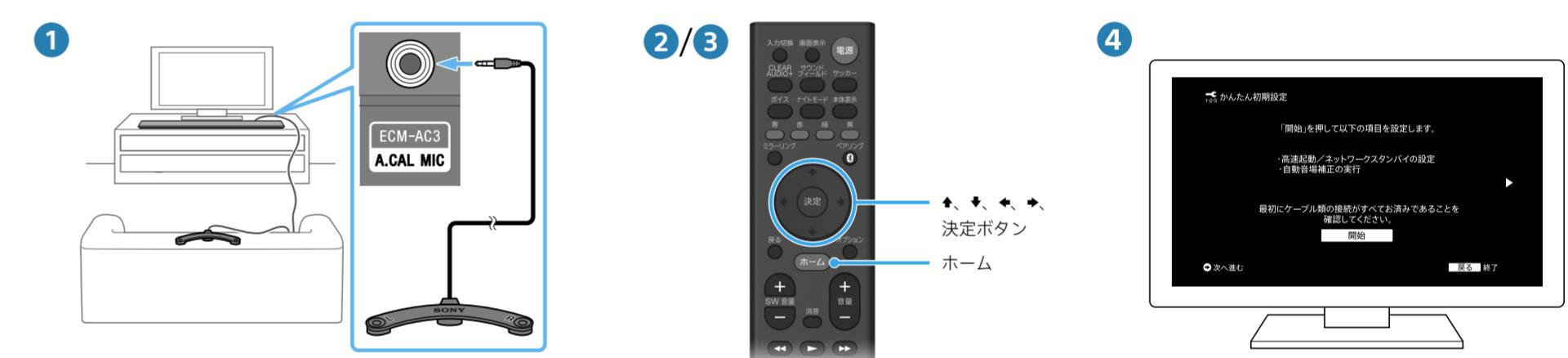
① 本体背面の A.CAL MIC (ECM-AC3) 端子に音場測定用マイクを接続する。
