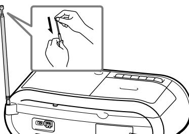
アンテナの先端を持ってゆっくりと押し下げて縮めてください。すばやく押し下げると、縮める際にアンテナが斜めになるなどして、途中で曲がったり、根元で折れたりする恐れがあります。
