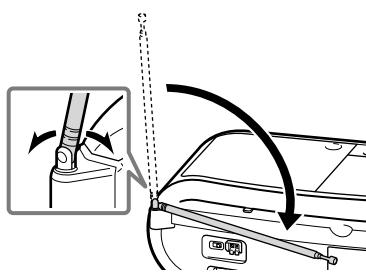
アンテナの付け根の構造上、図の方向にしか倒せません。不適切な方向に無理にアンテナを倒すと破損する恐れがあります。
