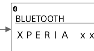
接続が完了すると、BLUETOOTHアイコン(Bluetooth)が点滅から点灯に変わります。接続した機器の名称が取得された場合は、表示窓に名称が表示されます。
