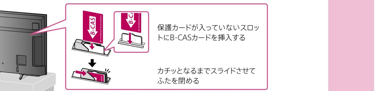
「スカパー！プレミアムサービス」を視聴する場合は、「スカパー！プレミアムサービス」に加入申し込み後に送付される本機専用の「スカパー！プレミアムサービス」対応のICカードを挿入してください。
