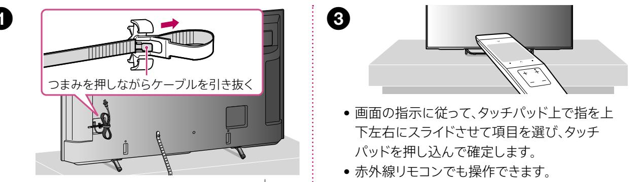
・画面の指示に従って、タッチパッド上で指を上下左右にスライドさせて項目を選び、タッチパッドを押し込んで確定します。
