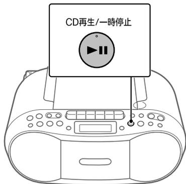
再生中は、現在再生している曲の情報が表示窓に表示されます。表示切換/決定ボタンを繰り返し押すと、情報が切り換わります。
