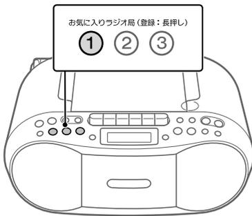
「ピー」の音とともに表示窓に**お気に入りラジオ局(登録：長押し)**ボタンの数字が点灯し、登録が完了します。
