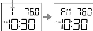
電源が入った状態で①、②、③のいずれかのボタンを押したときは、他の機能を使っていてもラジオ機能に切り換わり(テープへの録音中は除く)、選択したボタンに登録されている放送局の放送を受信します。
