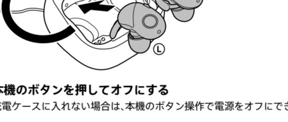
L側のボタンを、青ランプが点滅するまで押し続けます(約2秒)。このとき、R側もL側と連動して電源が切れます。
