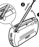
不適切な方向へ動かそうとすると、アンテナを破損する恐れがあります。おもて面の「ロッドアンテナの取り扱いについて」をご覧ください。
