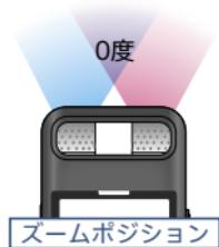
本体を15 cm~20 cm離して、口の高さに合わせて正面に設置しましょう。息がかかるときは、ウインドスクリーンを取り付けるか、息を避けるように本体を上向きにして録音しましょう。もしくは、イラストのようにマイクと口の間にポップガードを置くのもおすすめです。
