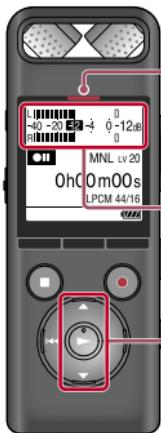
音量が大きすぎる(0 dBを超える)とピークランプが赤く点灯します
