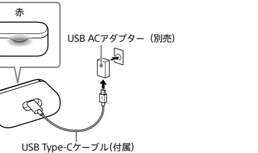
付属のUSB Type-Cケーブルと別売のUSB ACアダプター(推奨: AC-UD20)を使用します。
