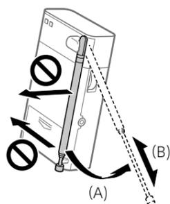
FMアンテナを長く伸ばして、受信状態の良い方向を探してください。
