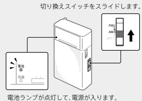
ラジオの電源を切るには切り換えスイッチを「OFF」にスライドします。
