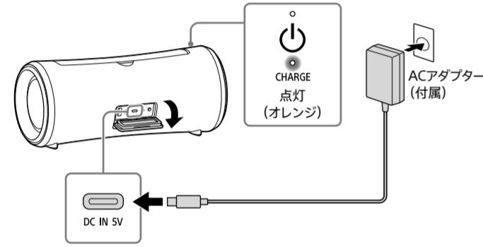
充電が始まり、CHARGEランプがオレンジ色に点灯します。約5時間\*で充電が完了し、ランプが消灯します。
