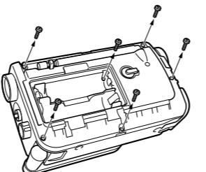
2 基板のねじを取って基板を取りはずし、内蔵充電池と基板をつなぐコネクターをはずす。
