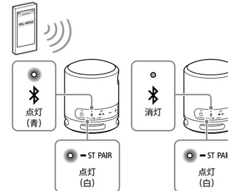
BLUETOOTH接続について詳しくは、おもて面のA~Cをご覧ください。BLUETOOTH機器を再生して、適度な音量に調整してください。一方のスピーカーで音量調整すると、もう一方のスピーカーの音量も自動で調整されます。ステレオ再生は、※(BLUETOOTH)ランプが点灯しているスピーカーは左チャンネル(L側)に設定されています。
