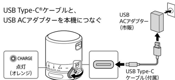
充電が始まり、CHARGEランプがオレンジ色に点灯し、充電が完了するとランプが消灯します。(内蔵充電電池が満充電の場合は、約1分後に消灯します。)0.5 A (500 mA)以上を出力できる市販のUSB ACアダプターに付属のケーブルを接続した場合、約4時間30分\*で充電することができます。
