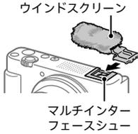
動画撮影時に、内蔵マイクで風音が記録されてしまう場合に風音を低減できます。ウインドスクリーンをマルチインターフェースシューに取り付けてください。
