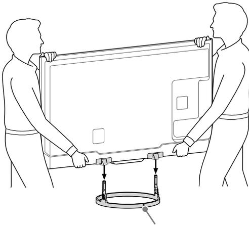
転倒防止用ベルト取付ネジの穴
