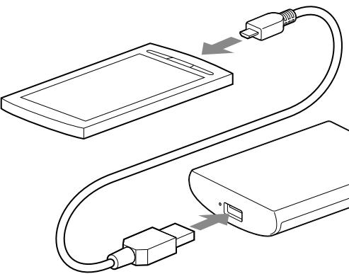
\* 給電が完了しても給電表示ランプは消灯しません。本体のUSBポート(給電用)からケーブルを抜くと、給電表示ランプは消灯します。充電の状態は、お使いの機器側でご確認ください。
