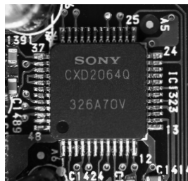
■写真9: A/VシンクIC、CXD2064
