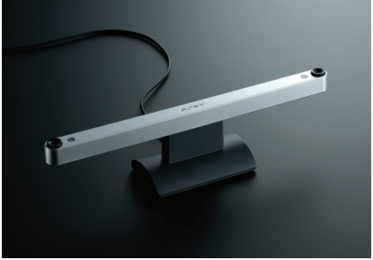
●写真1：音場測定用の2点マイクロホン
