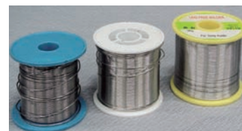
●写真8: ソニーのオーディオ機器に採用されたはんだ。左から有鉛はんだ、無鉛はんだ、高音質無鉛はんだ
