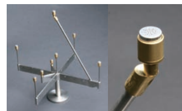
●写真2: 左) 新開発された近接8点マイク 右) 8点マイクの頂点に取り付けられた小型マイクカプセルのアップ
