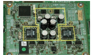
●写真1: デジタルボード上に配置されるDSP基板。デコーダー用DSPを含む2つのDSPはBGA実装されているため、一般的な実装で側面にあるリード線が見えない。DSPの間にあるのが専用の電源部
