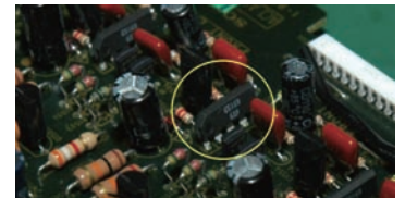
●写真3: リードのあるトランジスタを使っている「第二世代 広帯域パワーアンプ」の初段回路
