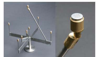
●写真2: 左) 新開発された近接8点マイクロホン 右) 8点マイクロホンの頂点に取り付けられた小型マイクカプセルのアップ
