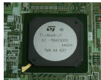
●写真1：映像処理用LSIに採用されたSTmicro社の「FLI8668-LF」
