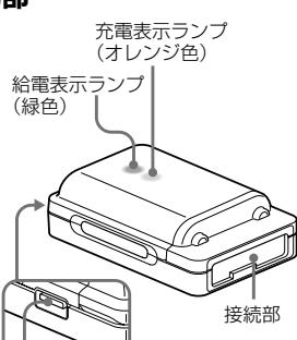
**電池収納部**
