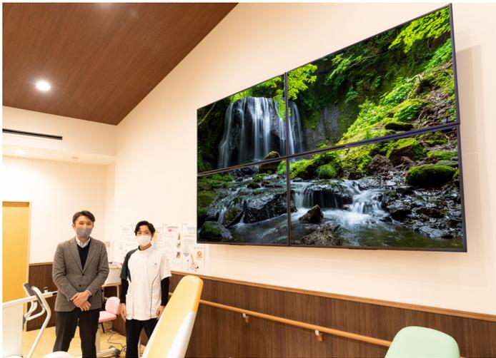
なお、今回は壁面設置に際して上下左右に画面を動かせる壁掛け金具を採用し、位置合わせも容易に行えるようにしています。この金具は画面を水平方向に傾けることもできるため、配線の調整などテレビの背面側にアクセスしたい時は画面を少し開いて作業スペースを作ることができます。
