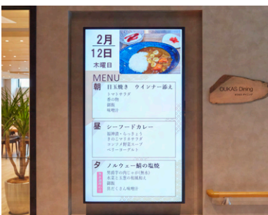
USBメモリーだけでコンテンツを表示。STB などがなくスッキリとした設置に。
