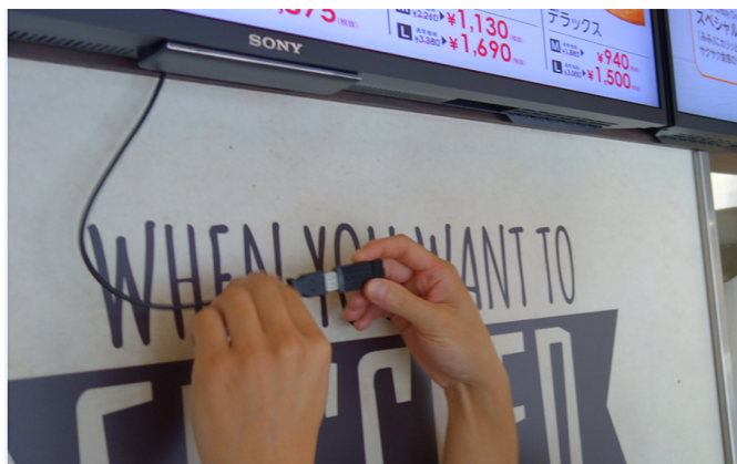
ディスプレイと接続した延長ケーブルにUSBメモリーを差しこむだけでコンテンツを切替え
