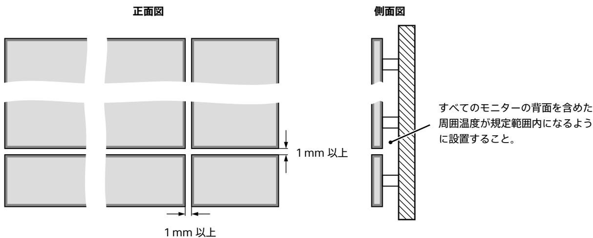
ただし、横置で横1列のマルチスクリーン設置の場合は、左右のモニター間の距離を1mm以上離さずに設置することができます。隣り合うモニターの荷重がかからないように注意して設置してください。
