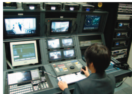
「ハービス・スタジオ」内のコントロール卓。リモートコントロールユニットRM-BR300で3式のBRC-H700をマニュアル操作で切り換えながらコントロールしています
