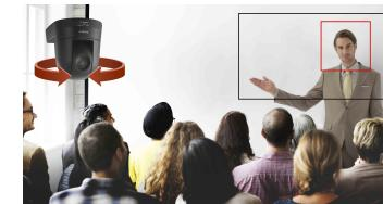
話者の動きに合わせ、PTZカメラを自動で旋回させるアプリケーションです。まるでオペレーターがマニュアルで操作しているかのような細やかなカメラ操作を自動で行えます。
