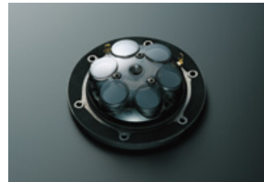
6つのマグネットを同心円状に配置し、背圧のストレスを排除したトゥイーターユニット
