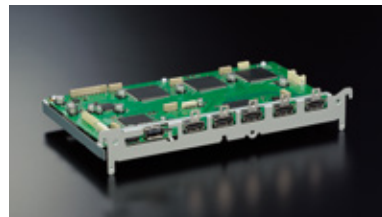
一体成型メタルフレーム・デジタル系回路基板
