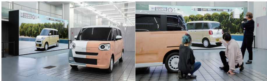
クルマのクレイモデルと Crystal LED を活用してデザイン検証を行う様子
