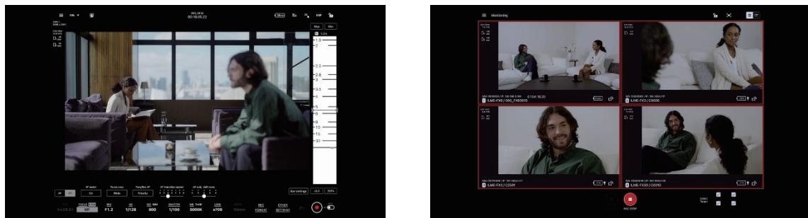
Monitor & Control (M&C) は1台のカメラに接続し、カメラのリモート操作やカメラからのクリップの表示・制御に使用するアプリケーションです。マルチカメラモニタリング機能 (iPadのみ) を使用して最大4台まで接続することも可能です。M&Cアプリは無料でご利用いただけます。
