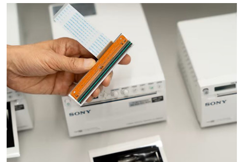
ソニーのメディカルプリンター UP-898 シリーズに搭載されているサーマルプリントヘッド
