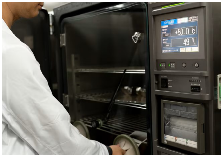
プリントメディア開発の環境試験。温度や湿度を変えて、品質に異常がないかを確認
