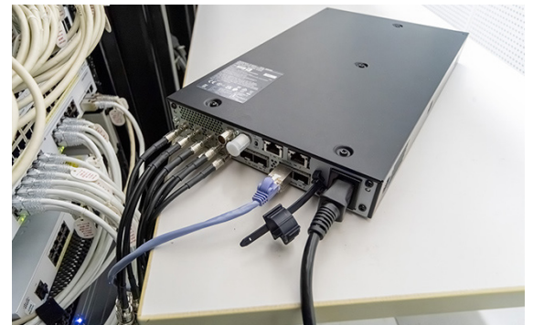
1式で最大8チャンネルの伝送に対応しながらも、コンパクトな1U ハーフラックサイズの筐体
