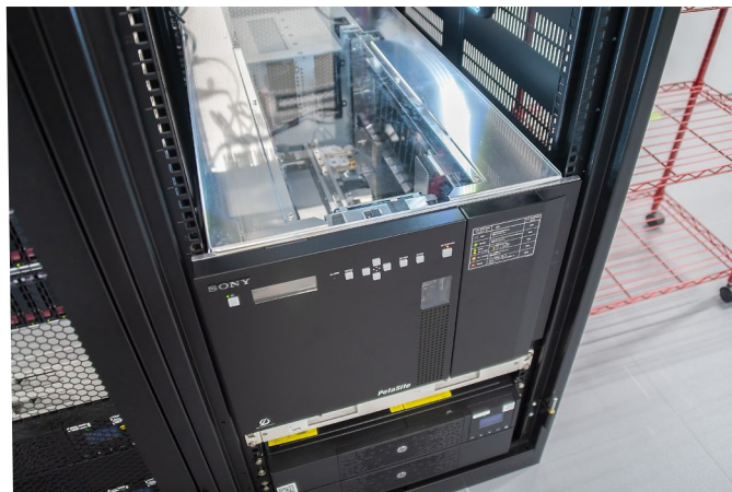
ODA PetaSite 拡張型ライブラリマスターユニット ODS-L30M は、内部構造が分かるように、天板はアクリル製。
