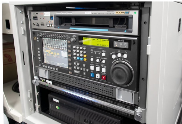
VTRとPWS-100TD1が収められた手動インジェストシステムのラック。PWS-100TD1は2系統ごとに1台。
