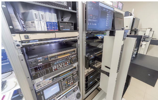
PWS-100TD1×1式とカセットローダによるVTR 2系統の自動デジタイズに対応
