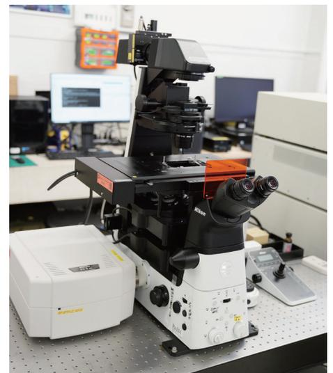
Nikon製共焦点レーザー顕微鏡システム「A1Rsi+」を使用してデータを取得
