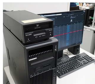
4Kアーカイブに運用されているODS-D77U。HDDにバックアップされた4Kコンテンツをオプティカルディスク・アーカイブに転送しています。
