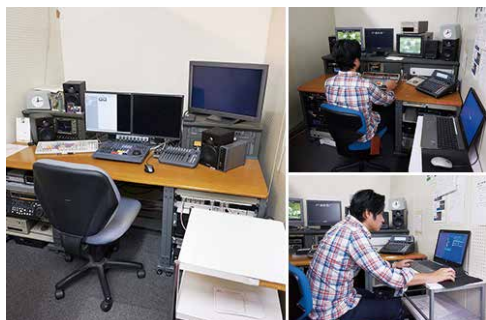
編集ブース。XPRI NSを採用した編集室(写真・左)などノンリニア編集室が2 室とBVE-700によるリニア編集室(写真・右上)2室で構成。リニア編集室には、ベースバンド素材をファイル化するためのPC 端末(写真・右下)も装備されています。
