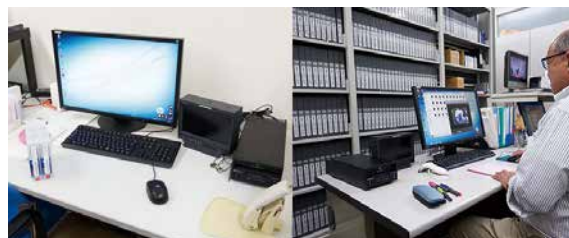
ライブラリー室にオプティカルディスク・アーカイブドライブユニット ODS-D77U を2 式導入。大容量、高速データ転送、優れた検索性などから主に過去素材のディープアーカイブ用途で運用中。ビューアーで素材確認がスピーディーに、的確に行える点でも好評をいただいています。
