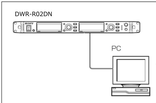
2. DWR-R02DN の電源を入れ、UTILITY->NETWORK で DWR-R02DN の IP アドレスを確認します。
