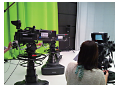
スタジオカメラに採用されたデジタルトライアックスカメラHSC-300×3台。
